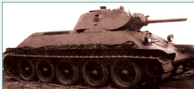
Серийный танк Т-34 выпуска 1940 года с 76-мм пушкой Л-11, установленной в сварную башню
