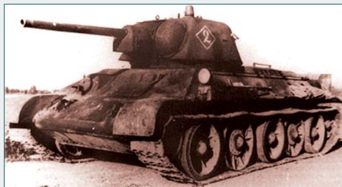
Т-34 1942 года. Вооружался 76,2-мм танковой пушкой Ф-34 и двумя пулеметами ДТ (башня литая или штампованная). Для увеличения свободного объема в башне опоры цапф пушки были вынесены вперед, что привело к появлению на башне выпуклой наделки. Литая или штампованная башня получила шестигранную форму. Устанавливаемая пятискоростная коробка передач (вместо четырехскоростной) улучшила тяговые характеристики двигателя. Катки употреблялись либо с обрезинкой, либо с внутренней амортизацией, как сплошные, так и облегченные, с ребрами жесткости, к тому же в разных сочетаниях. Радиостанция теперь устанавливалась на всех танках, а не только на командирских (9-Р вместо менее мощной 71-ТК-3)
