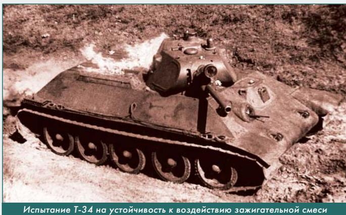
Испытание Т-34 на устойчивость к воздействию зажигательной смеси
