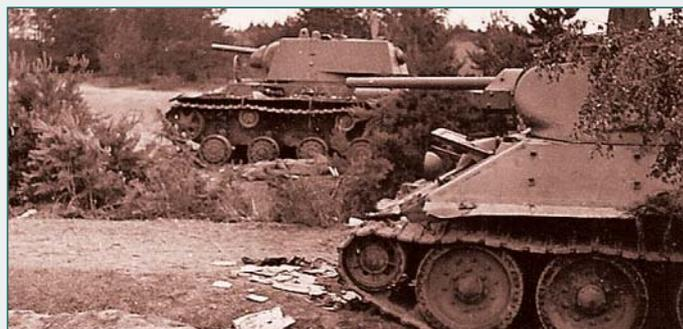
Т-34 с пушкой Ф-34 (на заднем плане танк КВ-1). На танках 1941 года выпуска перешли к безбалочному креплению передних краев лобовых броневых листов. Теперь они соединялись сварным швом. Изменилась форма бронировки откатных приспособлений пушки. По аналогии с машинами ранних выпусков стала устанавливаться литая башня, впрочем, сохранившая форму предыдущей - сварной. Изготовление литой башни облегчило производство и позволило увеличить выпуск танков
