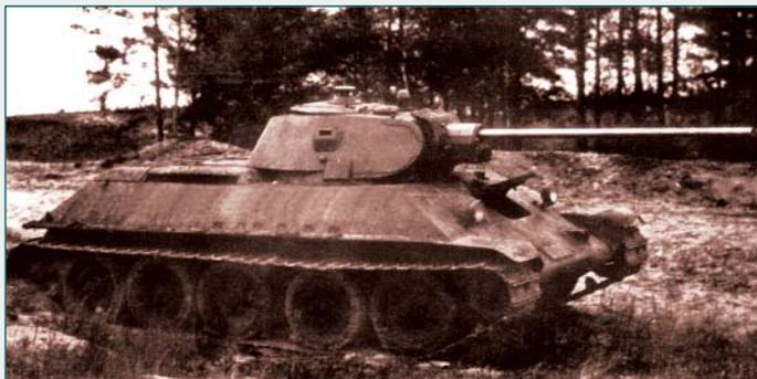
Опытный средний танк Т-34 с 57-мм танковой пушкой ЗИС-4 (Т-34-75) во время испытаний на Софринском полигоне в июле 1941 года.
