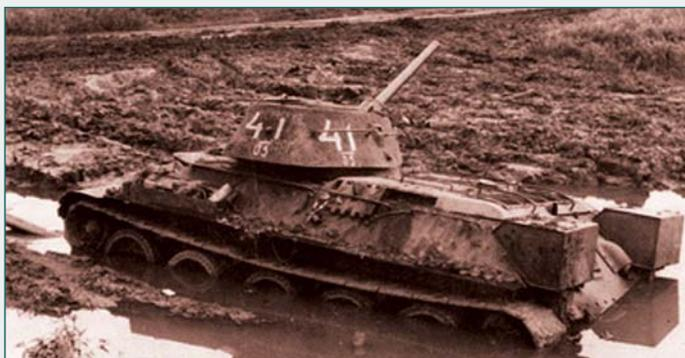
Т-34 1941-1942 гг. Вооружен 76,2-мм танковой пушкой Ф-34 и двумя пулеметами ДТ. Вместо дизельного двигателя В-2 устанавливался авиационный карбюраторный двигатель М-17Т-34.
