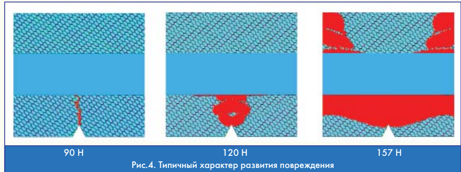
Рис.4. Типичный характер развития повреждения
