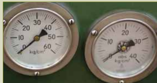
Оба манометра подключены к одной магистрали, но левый проградуирован в а.т.и., а правый - в а.т.а. Их показания отличаются на "1"
