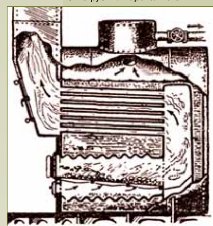
Огнетрубный паровой котел
