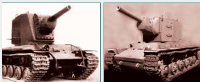
Башня КВ-2 с наклонными (слева) и прямыми (справа) скуловыми бронеплитами. Башня с прямыми бронеплитами имела меньшую высоту и массу
