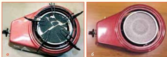
Рис. 2 Сопоставление прочностных свойств ИК-горелок из керамики (а) и ППМ (б)
