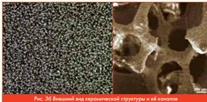
Рис. 3б Внешний вид керамической структуры и её каналов
