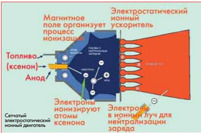
В то время как ускоряющая камера ионного двигателя выбрасывает заряженные частицы только одного знака, аппарат с ионными двигателями, чтобы остаться нейтральным, должен выделять с одинаковой интенсивностью положительно и отрицательно заряженные частицы.
