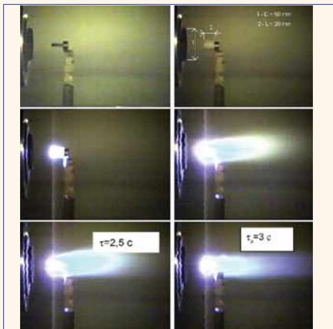
Рис. 11б. Результаты торцевого горения в воздушном сверхзвуковом потоке малого образца твердого легкоплавкого углеводородного горючего при числе Маха полета M_p=4 и числе Маха камеры M_k=2 , скорость горения U_g=1 мм/с (ЦИАМ, П.К. Третьяков ИТПМ СО РАН, ГНИИХТЭС)
