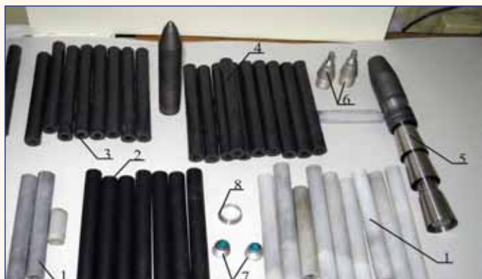
Рис. 11а. Образцы первых опытных партий "твердого керосина" и "твердого металлокеросина" для реактивных МЭ-30: 1 - "твердый керосин" [9]; 2 - "твердый металлокеросин"; 3 - "твердый боркеросин" (с порошком бора); 4 - "твердый титан-алюминиевый-керосин"; 5 - реактивный МЭ-30 на "твердом керосине" и "твердом металлокеросине"; 6 - наконечник МЭ-30; 7 - пирозапалы; 8 - сопло встречных струй камеры вихревого смешения
