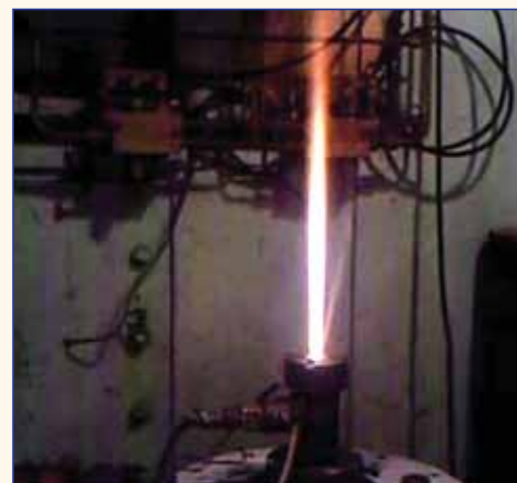
Рис. 4б. Стенд с модельным ракетным двигателем в процессе испытаний ПГГС (Н.П. Животов, ОАО "МКБ "Искра", ФГУП "РНЦ "Прикладная химия")
