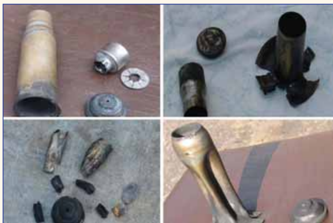
Рис. 6. Разрушение штатных гильз в результате нерасчетных режимов ствольного реактивного разгона МЭ-30 (ЦИАМ, ИХФ РАН)
