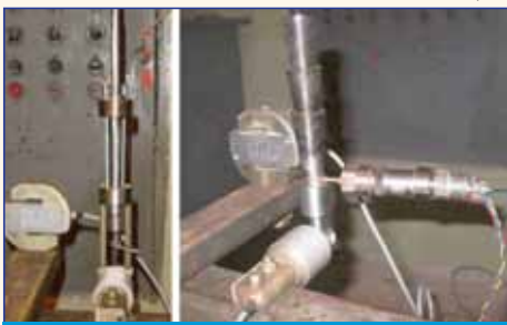
Рис. 8. Стелды измерения отдачи и тяги малых метательных устройств и метаемых элементов (А.П. Иванов, ЦИАМ)
