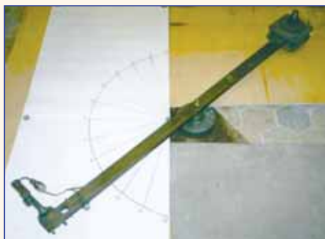
Рис. 7. Малые метательные устройства и стелды замера их импульса отдачи (А.П. Иванов, ЦИАМ)
