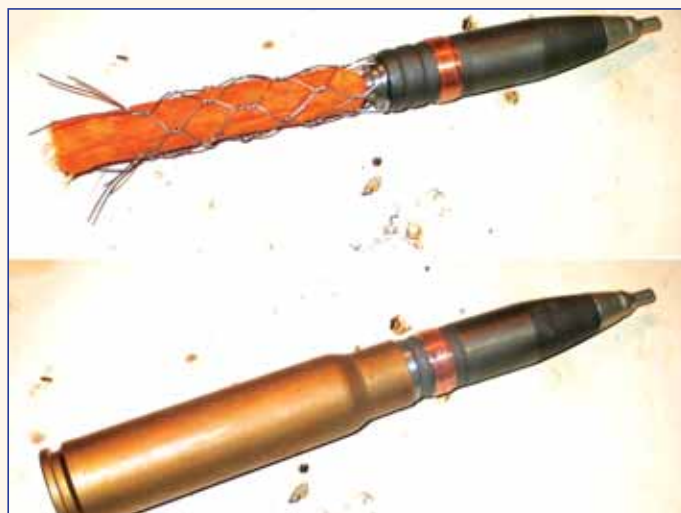
Рис. 2. Демонстрация сгорающего ствольного ракетного двигателя на ПГГС перед пуском модели метаемого летательного аппарата штатным нарезным МУ (А.П. Иванов, ЦИАМ)
