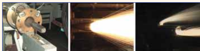
Рис. 12. Горение ПГГС в едином блоке управления и тяги образца гиперзвуковой реактивной военной техники (ЦИАМ, П.К. Третьяков ИТПМ СО РАН, ФГУП "РНЦ "Прикладная химия")
