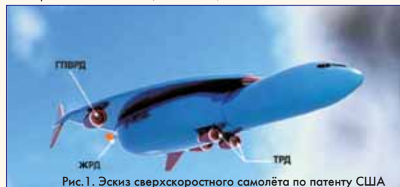
Рис.1. Эскиз сверхскоростного самолёта по патенту США
