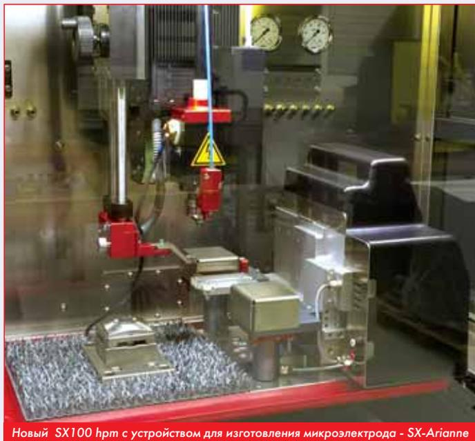
Новый SX100 hpm с устройством для изготовления микроэлектрода - SX-Artipne
