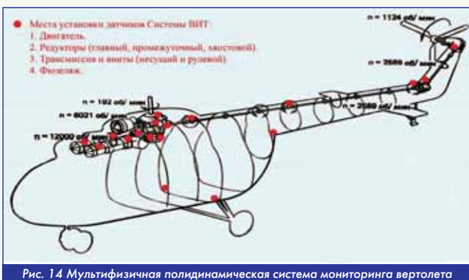
Рис. 14 Мультифизическая полидинамическая система мониторинга вертолета
