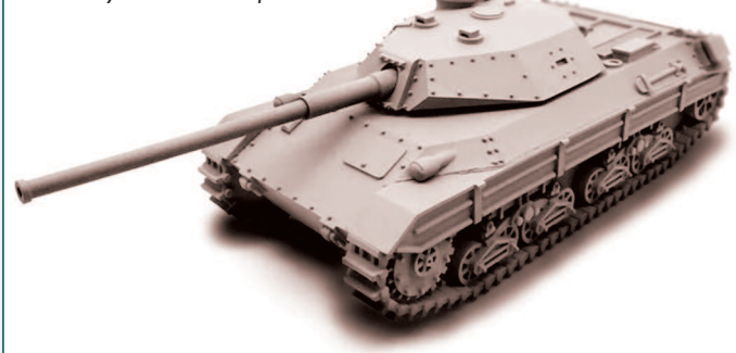
"Carro Armato P 43 bis" с 90-мм пушкой 53 калибра
