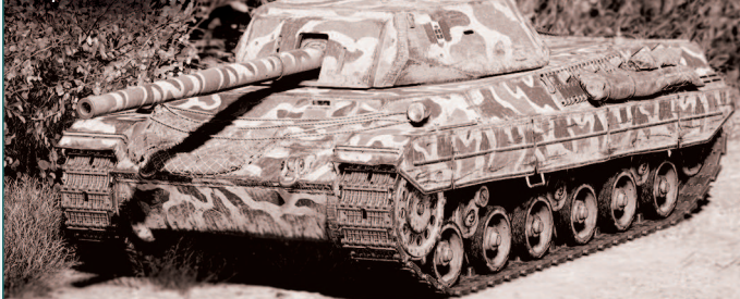
"Carro Armato P 43 bis" с торсионной подвеской
