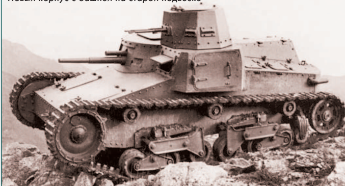
Новый корпус с башней на старой подвеске
