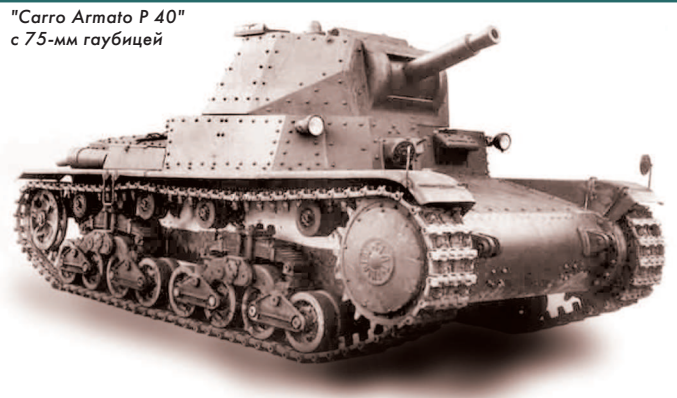
Первый опытный образец "Carro Armato P 40" с 75-мм пушкой (32 калибра)
