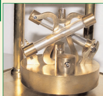
Рис. 4 Крутильный маятник ртутной термокомпенсацией [5]
