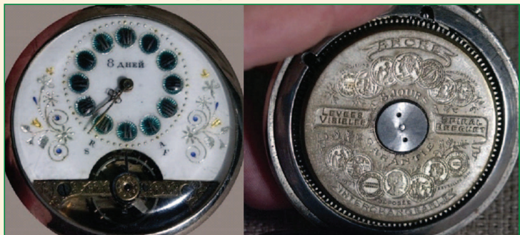
Рис. 12 Часы карманные механические с восьмидневным заводом. Швейцария. Шо-де-Фон 1910-1913. Надписи: на циферблате: "8 дней"; на механизме: "ANCRE", "8 Jours", "Levees Visibles", "Spiral Breguet", "Garantie", "Deposee"; на механизме: "Interchangeable" (заменяемый), "Expositions", "Universilles", "Milan 1906", "Bruxelles 1910"
