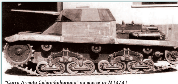
"Carro Armato Celere Sahariano" на шасси от M14/41
