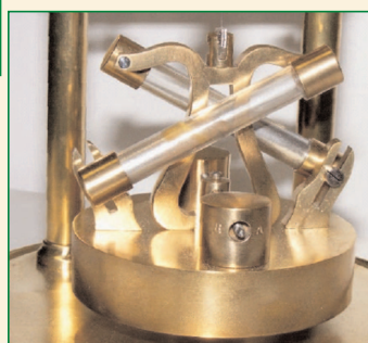
Рис. 4 Крутильный маятник ртутной термокомпенсацией [5]
