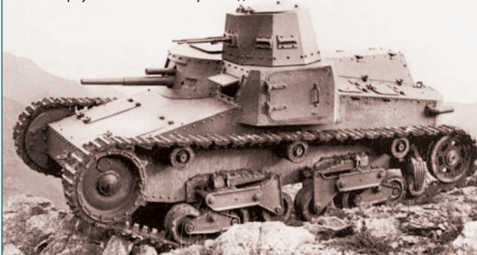
Новый корпус с башней на старой подвеске
