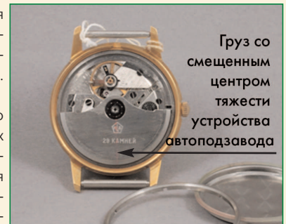
Рис. 9 Часы мужские, наручные "Полет" с автоподзааводом типа 2615 СССР. Москва. Первый московский часовой завод им. С.М. Кирова. 1970 г.
