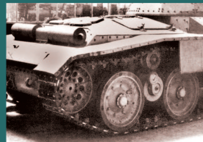
"Carro Armato Celere Sahariano" на шасси от M14/41
