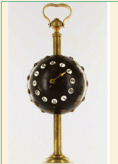
Рис. 6 Гравитационные пилообразные часы с автоподзааводом пружинного двигателя. Франция. Фирма "Ferrier". 1830 г.
